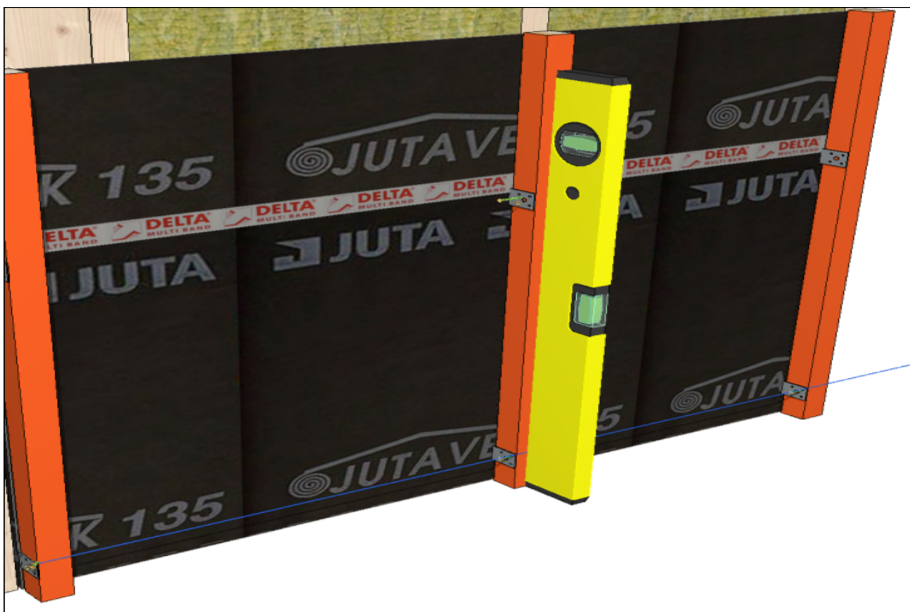
Выравнивание плоскости фасада с помощью "шнурки" и пузырькового уровня
