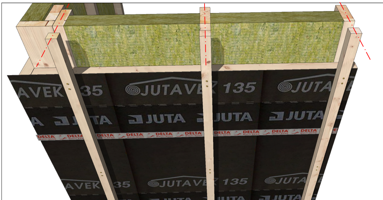
Соосность монтажа брусков вентзазора со стойками каркаса стен
