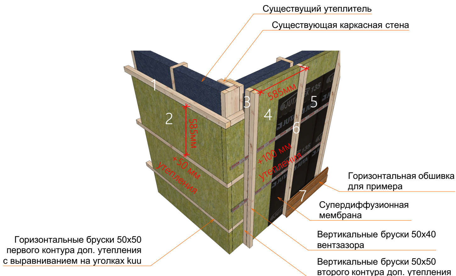
Монтаж перекрестного утепления 100 мм
