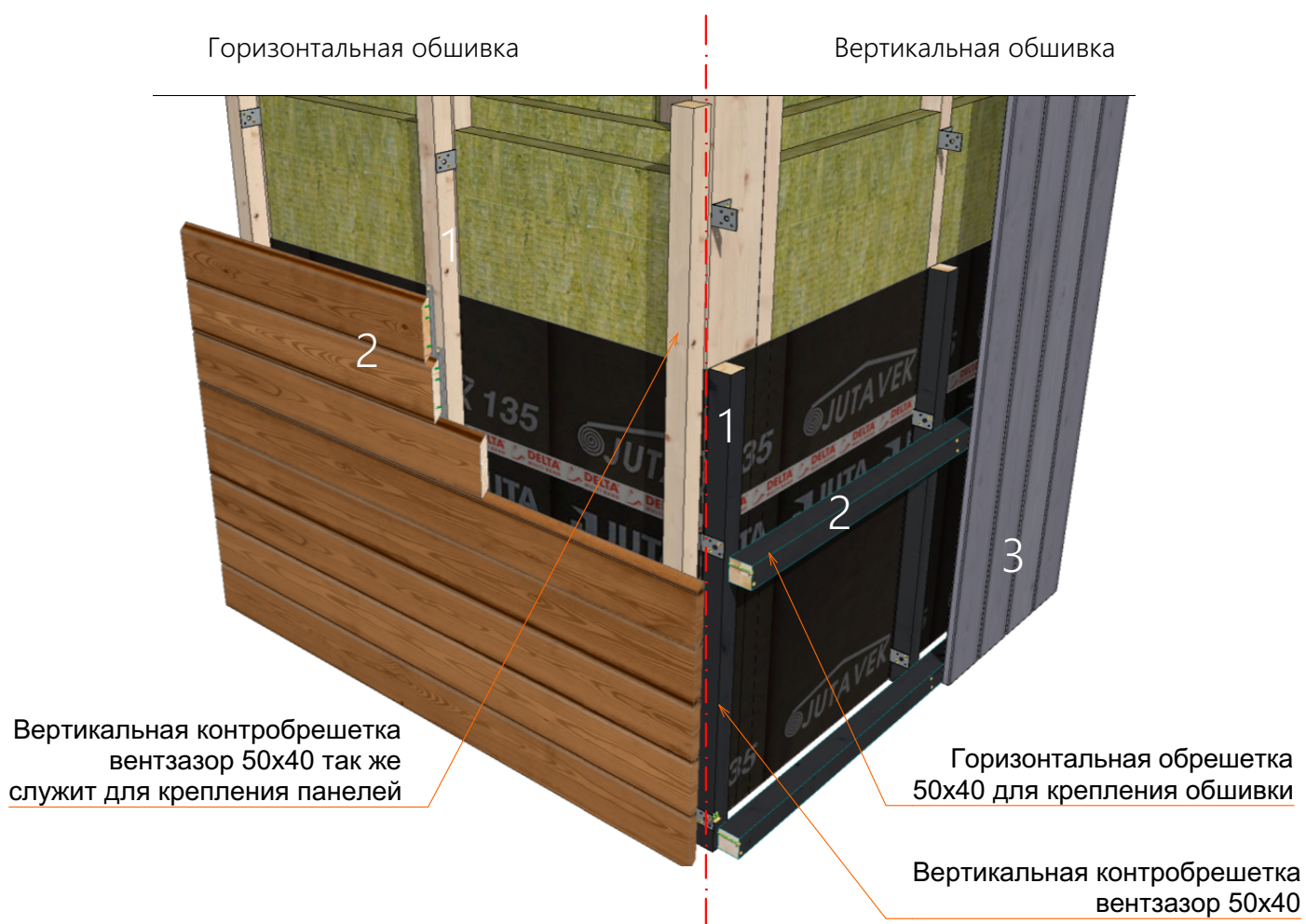
Деревянная подсистема под горизонтальную и вертикальную обшивки
